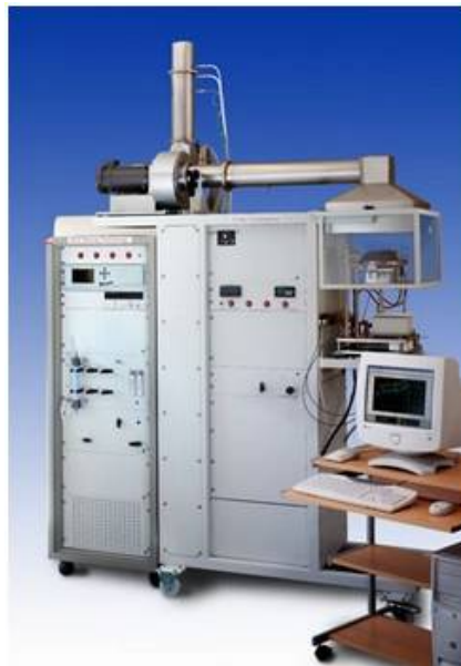
Fig. 1. Cono calorimetro utilizzato per le prove sperimentali
