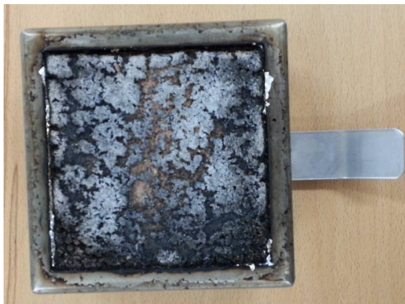
Figura 2. Campione di prova al termine della combustione.
