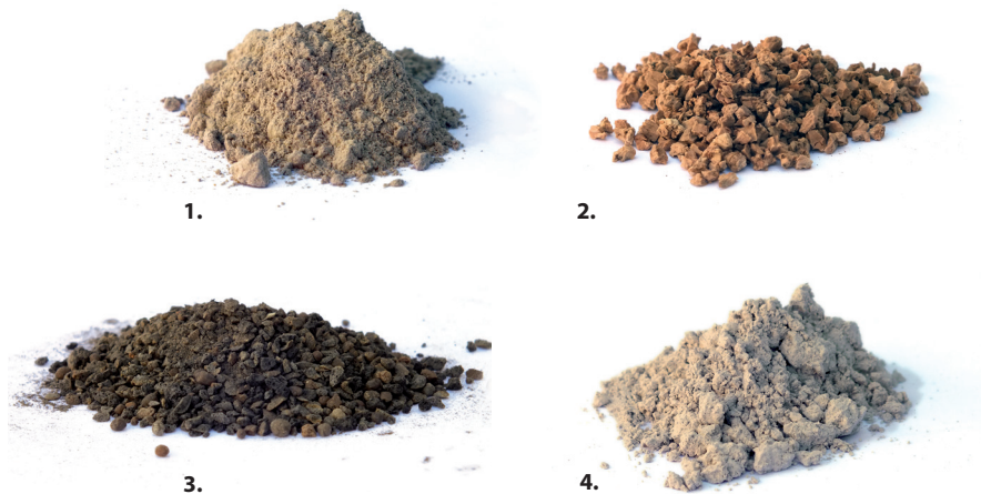
1. Pamant de diatomee / 2. Pluta/ 3. Lut/ 4. Var hidraulic
