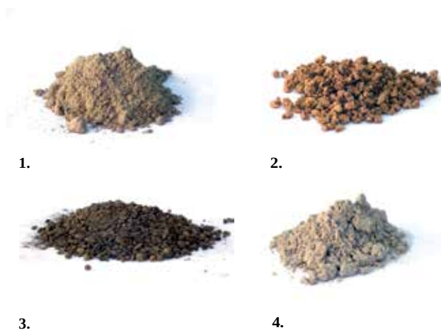
1. Diatomit / 2. Plută / 3. Argilă / 4. Var hidraulic natural
